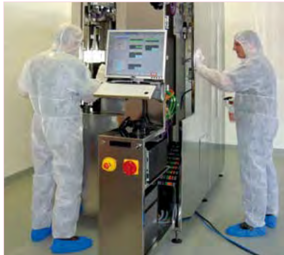
Reinraummaschine nach ISO-Klasse 3
