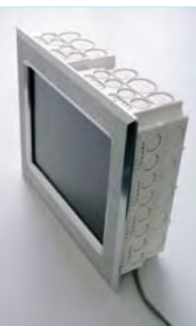
Die neuen Web-Panel gibt es auch als praktischer Wand-Einbausatz, bestehend aus Kunststoffbox, Web-Panel und abnehmbaren Frontrahmen.
