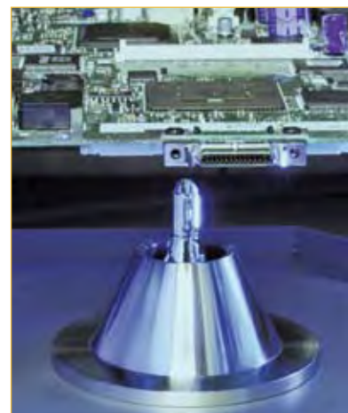
Einzellötstelle wie sie von der Kamera beim Löten überwacht wird
