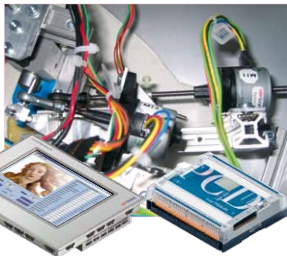
Im Hintergrund ist einer der vielen Saia®Schrittmotoren zu sehen, links das Saia®PCD Web-Panel und rechts die Saia®PCD2-Steuerung.
