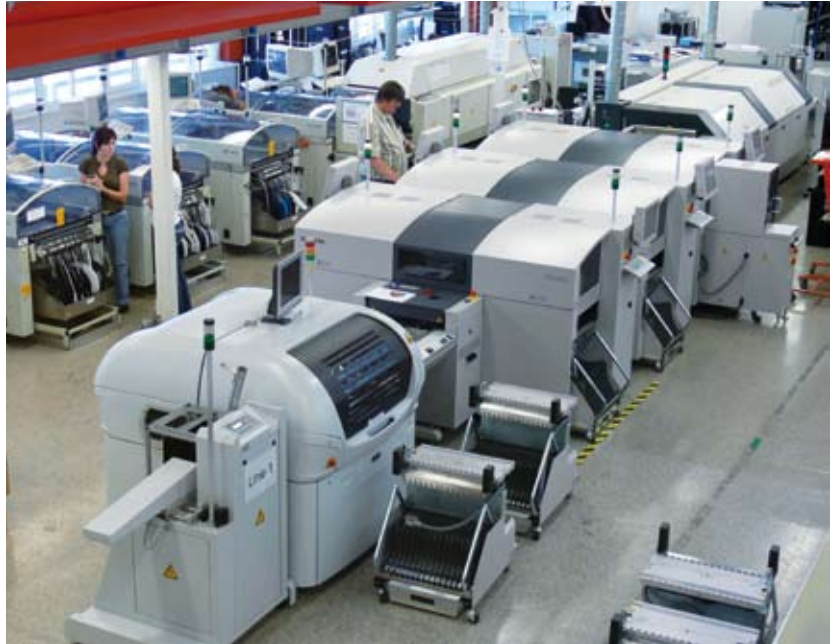
Produktion von Saia-Burgess Controls mit drei neuen Siplace SMD-Maschinen
