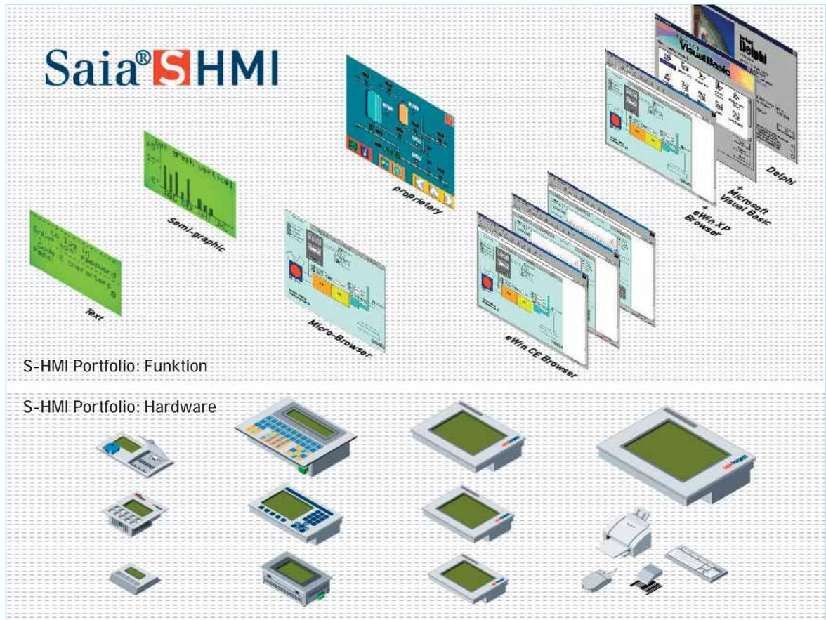
Das angeschlossene HMI-System kann im einfachsten Fall nur aus einem Text- oder Graphik-Display bestehen, das über ein digitales Breitbandsignal (z.B. LVDS) angesteuert wird. Es kann aber auch ein intelligentes HMI-Gerät sein, welches unterstützt. Die höchste Form von «Intelligenz» ist ein Touchpanel-Gerät mit embedded Windows XP. Die geringsten Kosten und den grössten Komfort bietet die Kombination aus einfachem Tastenfeld mit einem «off the shelf» PC.
