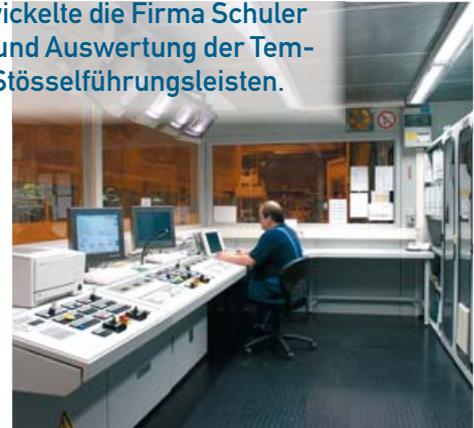
Bei Überschreitung eines Grenzwerts wird der Bediener unverzüglich informiert. Eine mechanische Überlastung der Stößelführungen kann dadurch vermieden werden. Der gesamte Temperaturverlauf wird in 2 Datenbanken dokumentiert, die eine Auswertung der jeweils letzten 20 Minuten erlauben.
