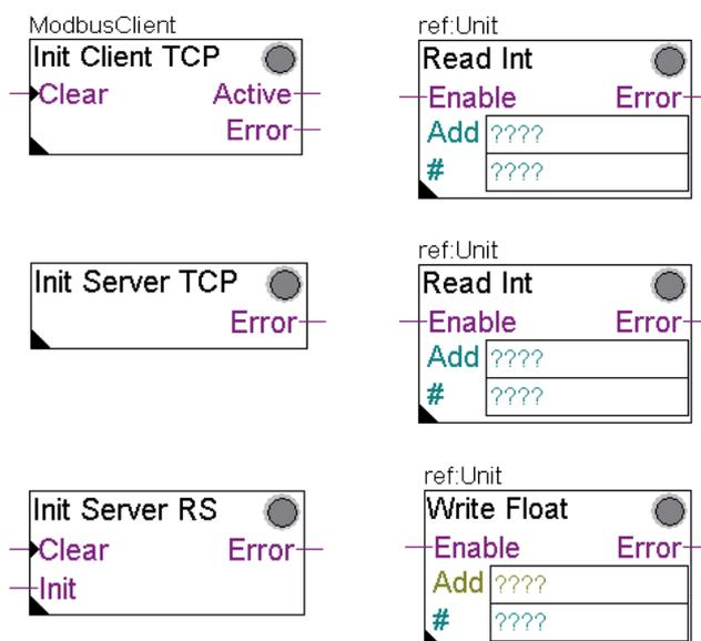
▲ Per la configurazione e la programmazione dello scambio dati si possono utilizzare dei comodi FBox FUPLA o comandi CSF.
