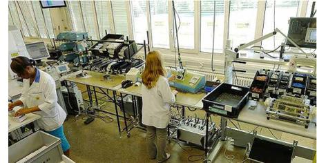
▲ Produktionszelle für Energiezähler
