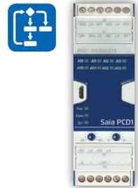
Das frei programmierbare Analogmodul mit einer Gehäusebreite von 35 mm (2 TE) verfügt über jeweils vier Ein- und Ausgänge. Jeder Ein- und Ausgang ist galvanisch getrennt und separat konfigurierbar. Es lassen sich somit kleine reine Analogaufgaben, wie z.B. das Erfassen der Raumtemperatur und anschließenden Ansteuern von 0...10 V Antrieben realisieren.
