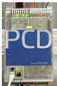
Utilisation comme interface de communication avec M-Bus dans un réseau de chauffage à distance
