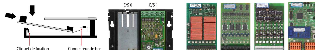
Seul un module PCD2.W525 qui est déjà fourni à la sortie d'usine peut fonctionner à l'emplacement d'E/S 1. Si le module est retiré, l'automate s'arrête.
