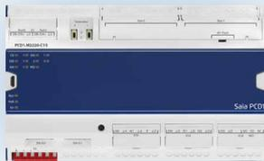
E-Line pour l'installation dans les coffrets de distribution est idéal comme interface maître et comme interface Ethernet pour les produits Saia PCD1 E-Line
