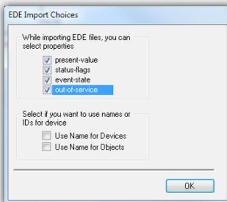
Il est possible de sélectionner plusieurs fichiers .ede à importer simultanément dans le configurateur BACnet. Une telle action entraîne la génération automatique des symboles généraux de tous les objets BACnet dans le dossier « BAC » : BAC.nom-appareil.nom-objet
