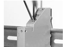
**5. Lösen des Moduls von der Hutschiene**
