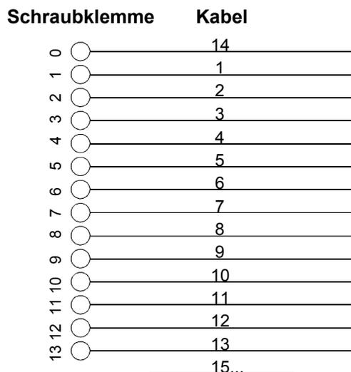
Ummanteltes Kabel mit 14 Litzen von 0.5 mm<sup>2</sup>.
