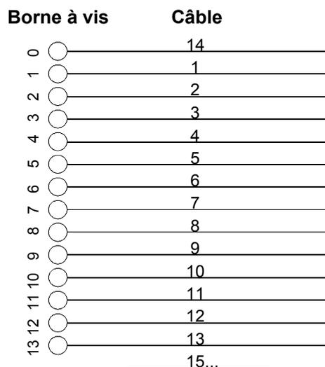
Câble rond et gainé, constitué de 14 conducteurs de section 0,5 mm<sup>2</sup>.
