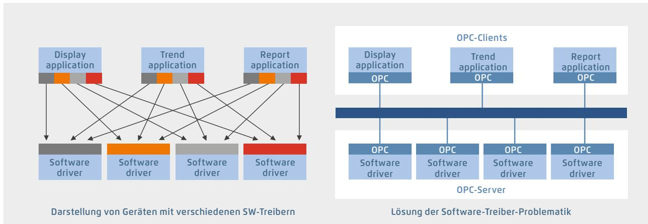
Durch die normierte OPC-Schnittstelle ist kein Know-how über herstellerspezifische Protokolle mehr nötig. Dadurch entsteht wesentlich weniger Aufwand für Entwicklung, Inbetriebnahme und Unterhalt.
