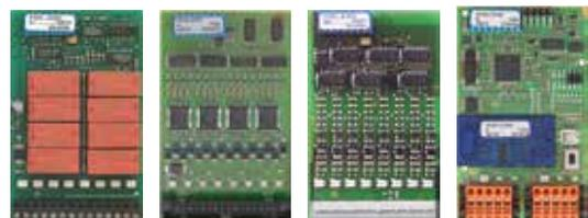
**!** Auf dem Steckplatz E/A1 funktioniert nur ein PCD2.W525-Modul, welches im Auslieferungszustand bereits mitgeliefert wird. Wird das Modul herausgenommen, geht die Steuerung auf Stop!
