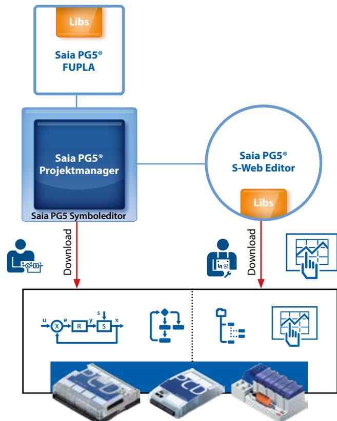
▲ MSR- und Web HMI Applikation können unabhängig von einander in die PCD Steuerung geladen werden
