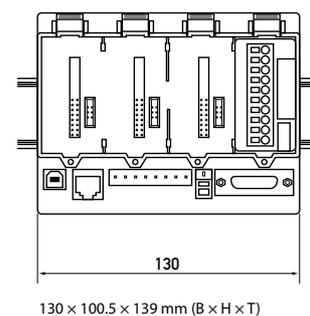
▲ Standard- und High-Power-CPU mit Steckplätzen für Batterie- und Speichermodule, Run-/Stop-Schalter und zusätzlichen Schnittstellen
