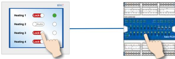
Bei Modulen mit manueller Vorrangbedienebene kann die Inbetriebnahme unabhängig von der Masterstation erfolgen.
