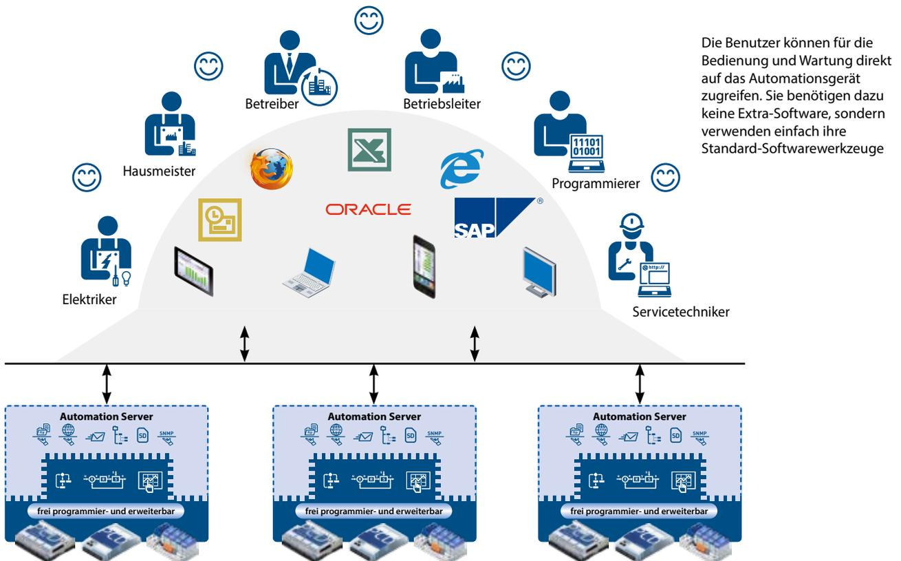
Idealerweise verfügt jedes Automationsgerät über einen Automation Server: auf jedes Gerät kann gleichberechtigt zugegriffen werden und komplexe Kommunikationshierarchien erübrigen sich.
