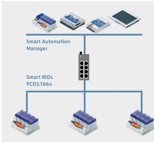
Als Smart Automation Manager können PCD1.M21x0-, PCD2.M5-, PCD3.M2/3/5-CPU's sowie die programmierbaren Micro-Browser-Panel PCD7.D4xxxT5F verwendet werden
