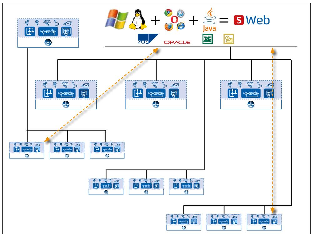
▶ Lean Automationssystem: alle Kernfunktionen der Automation (SPS+Web+IT) integriert in jedem Automationsgerät ermöglicht Integration und Interaktion aller Geräte von der Feld- bis zur Leitebene.
