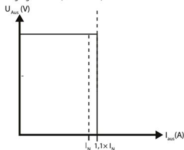
Der Stromüberlastschutz begrenzt den Strom auf einen konstanten Wert von  $1,1 \times$  Nenn-Strom
