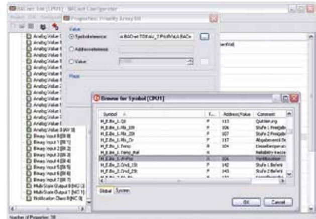
Automatische Generierung von BACnet®-Objekten und PCD-Ressourcen über FBoxen und Vorlagen.
