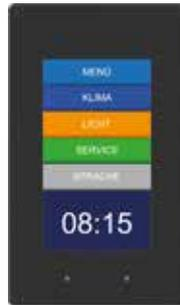
Die Lage des Panels kann die Temperaturmessung leicht beeinflussen. Eine einfache Kalibrierung ermöglicht es, dies zu beheben und erhöht so die Genauigkeit.
