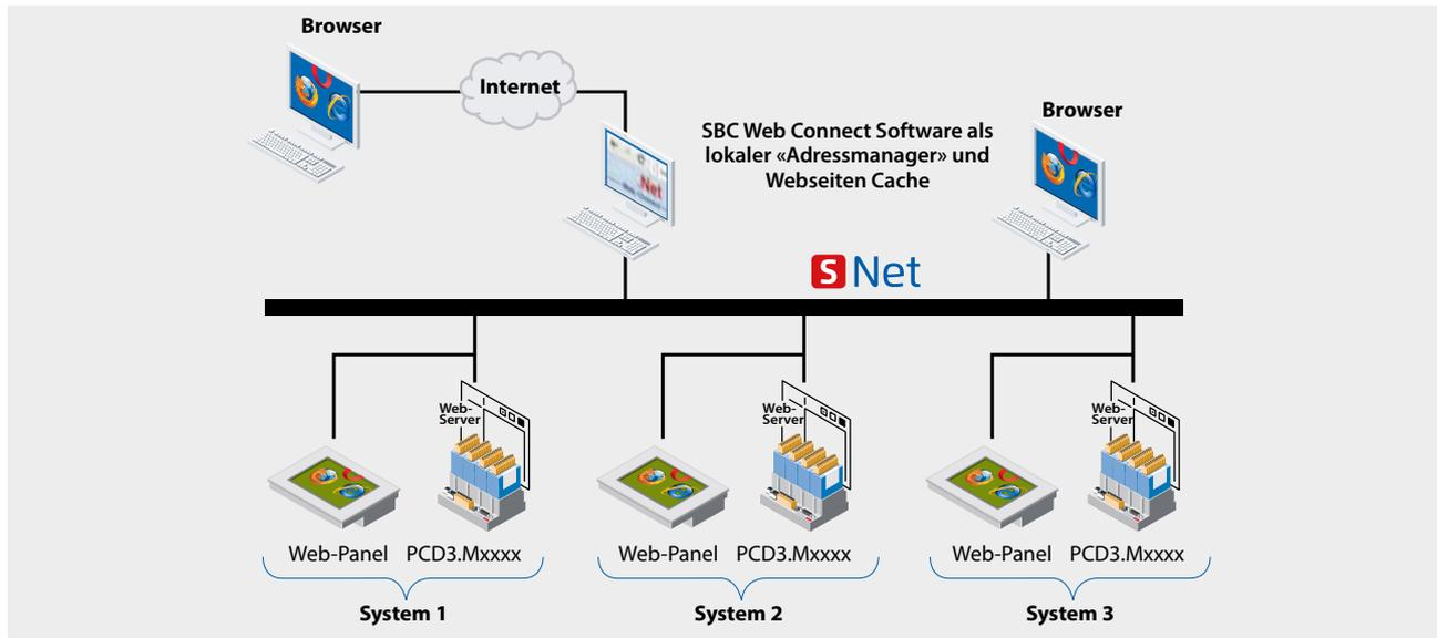
▲ Mit SBC Web Connect kann auch ohne öffentliche IP-Adressen auf die PCD-Web-Server im lokalen Netzwerk zugegriffen werden. Die Benutzeroberfläche ist immer die gleiche egal ob lokal oder remote bedient wird.
