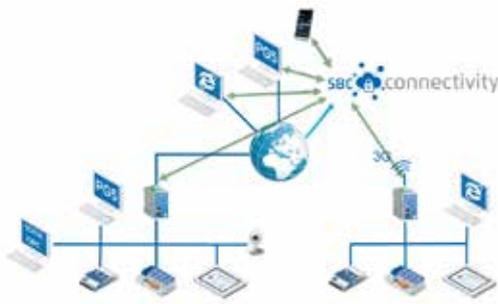
Mit dem „SBC Connectivity Service“, erhalten Sie Ihr eigenes verschlüsseltes VPN. In wenigen einfachen Schritten integrieren Sie lokal angeschlossene PCD Steuerungen, Web Panels MB wie auch PCs, Tablets oder Smartphones. Ihre Geräte sind damit über alle Netze hinweg durch gesicherte VPN-Verbindung erreichbar und jederzeit direkt ansprechbar.
