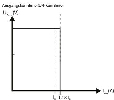
Der Stromüberlastschutz begrenzt den Strom auf einen konstanten Wert von  $1,1 \times$  Nenn-Strom
