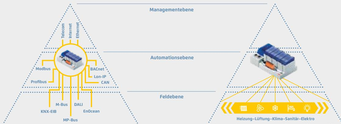
Die Saia PCD3-Power-CPU verfügt über genügend Systemressourcen, um bis zu 13 Kommunikationsschnittstellen im selben Gerät zu betreiben. Auch anspruchsvollste Aufgaben wie die gleichzeitige Kommunikation über BACnet® und Lon-IP werden zuverlässig erledigt.
