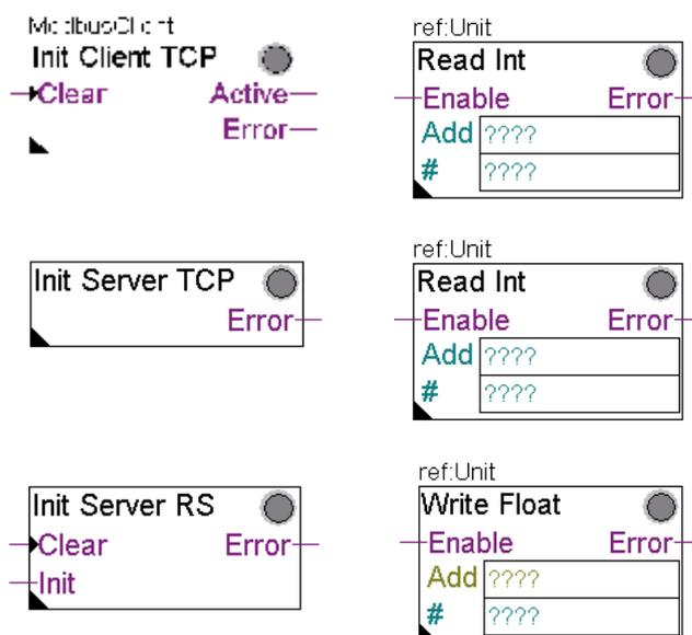
▲ Für die Konfiguration und Programmierung des Datenaustausches sind komfortable FUPLA-FBoxen oder CSF-Befehle verfügbar.
