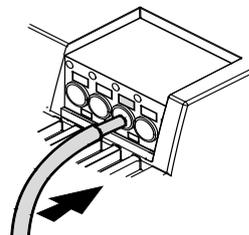
Querschnitt. Feindrängige Leiter bis zu 2,5 mm<sup>2</sup> können aber auch direkt mit einfacher Drückerbetätigung (Schraubenzieher) angeschlossen werden.
