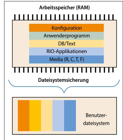
▲ Inhalt eines Systembackups, erstellt auf einem externen Modul mit Dateisystem.
