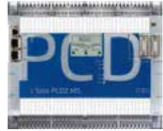
Die Saia PCD2.M5xxx ist aufgrund ihrer flachen Gehäuseform besonders für platzsparende Anwendungen geeignet. Der leistungsfähige Prozessor ermöglicht die Steuer- und Regelfunktionen von komplexen Applikationen mit bis zu 1023 zentralen Datenpunkten. Dabei lässt sich die PCD2 über steckbare Speichermodule zur Lon-IP®- oder BACnet®-fähigen Steuerung ausbauen. Die PCD2 hat Kommunikationsschnittstellen wie USB, Ethernet, RS-485 und Automation Server On-Board.
