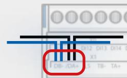
**!** Für die Busverdrahtung sind Kabel mit maximal 0.75 mm<sup>2</sup> Querschnitt zulässig. Gesamthaft gilt ein Kabelquerschnitt von 1.5 mm<sup>2</sup> pro Klemme.
