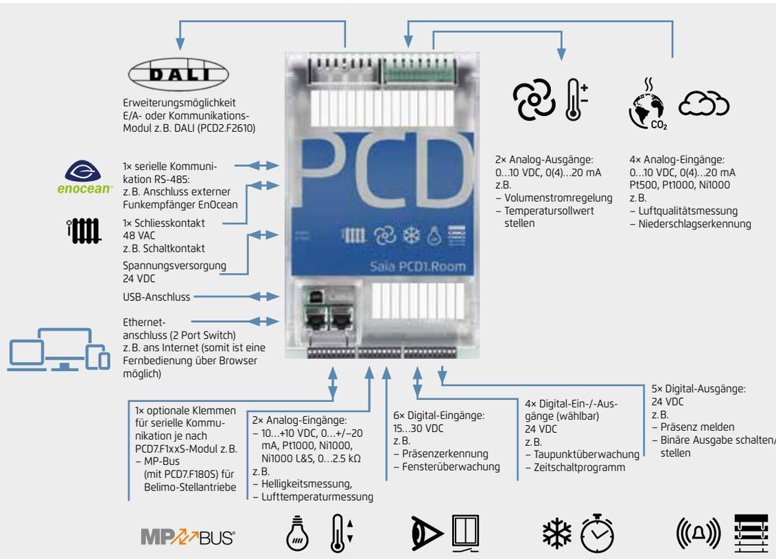
Beleuchtung, Sonnenschutz und Einzelraumregelung können mit diesem Controller optimal aufeinander abgestimmt werden. Angelehnt an Applikationen nach Raumautomations-Funktionsliste VDI 3813 und GA-Funktionsliste DIN EN 15232 zeigt das Beispiel eine mögliche Belegung.
