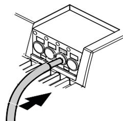
Querschnitt. Feindrätige Leiter bis zu 2,5 mm<sup>2</sup> können aber auch direkt mit einfacher Drückerbetätigung (Schraubenzieher) angeschlossen werden.
