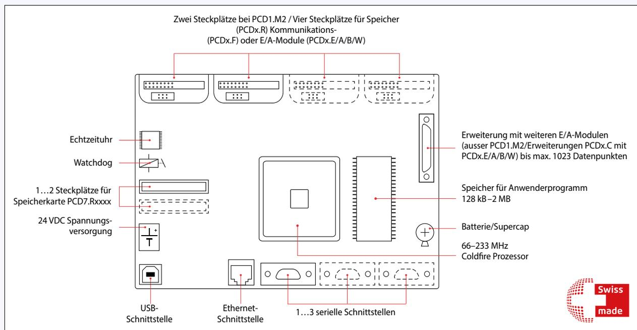
▲ Übersicht der Kern-Elemente einer Saia PCD Steuerung
