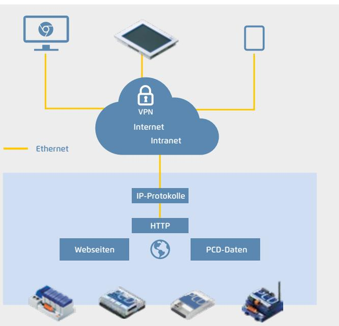
Hypertext Transfer Protokoll (HTTP) ist ein Protokoll zur Übertragung von Daten über ein Netzwerk. Mit Saia PCD wird das Protokoll für den Zugriff auf den PCD-Web-Server genutzt.
