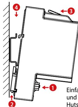
Einfache Montage der CPUs und Modulträger auf DIN-Hutschiene (1 x 35 mm)
