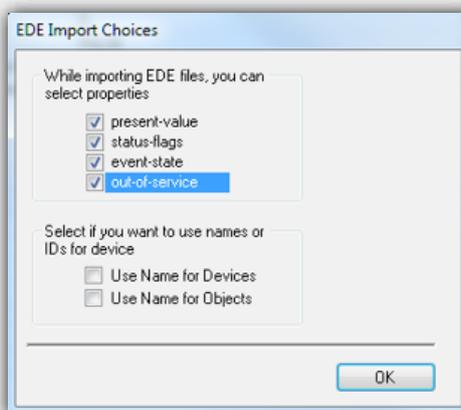
Mehrfachauswahl von mehreren, in den BACnet-Konfigurator zusammen zu importierenden .ede-Dateien ist möglich und erstellt automatisch die globalen Symbole aller BACnet-Objekte im Ordner „BAC“ mit folgender Struktur: BAC.Gerätename. Objektname
